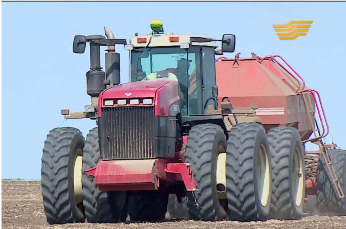
Рис. 10 Ходова система трактора зі строєними колесами
