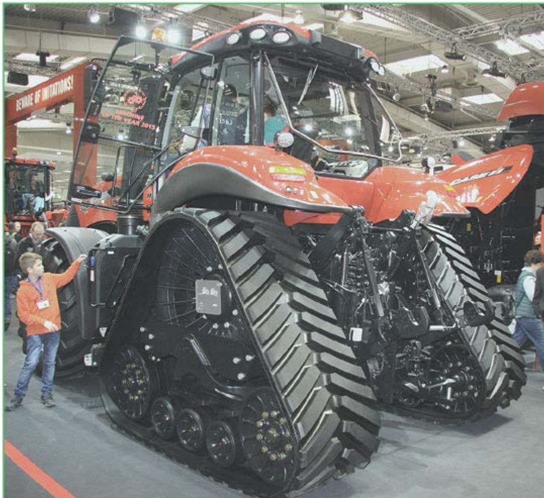
Рис. 11 Трактор Magnum 380 CVX від CASE ІН на гусеничному гумоармованому ході
