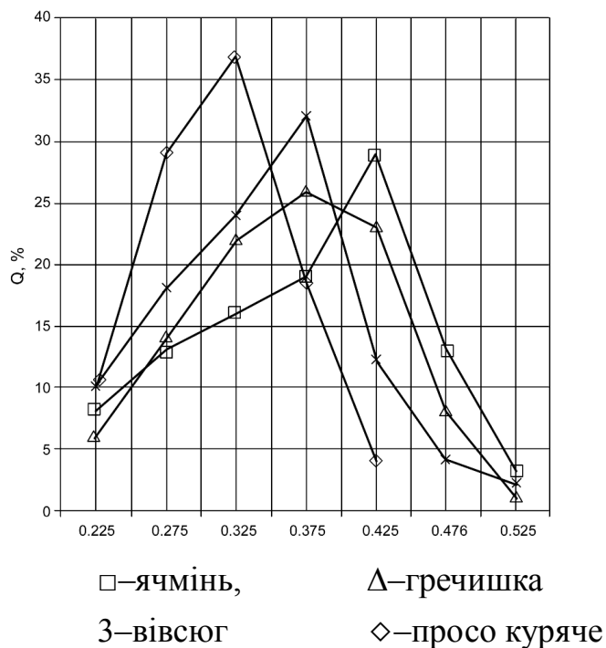
Рис.7 -Варіаційні криві розподілення значень коефіцієнтів миттєвого тертя при ударі насіння ячменю та домішок
