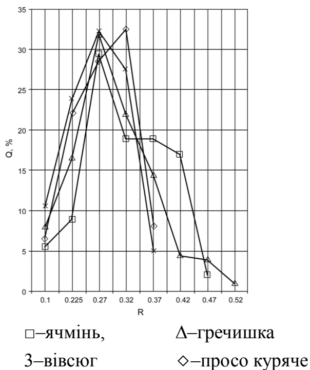
Рис.6 -Варіаційні криві розподілення значень коефіцієнтів відновлення швидкості при ударі насіння ячменю та домішок по брезенту
