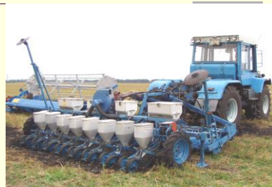
Почвообрабатывающее – посевной агрегат на базе фрезерного культиватора КВФ-4 и сеялки УПС-6
