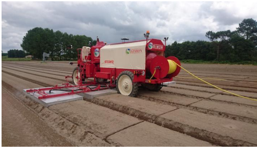
Рис 1. Машина для обробітку ґрунту паром від шкідників та бур'янів Simon Steam'R
