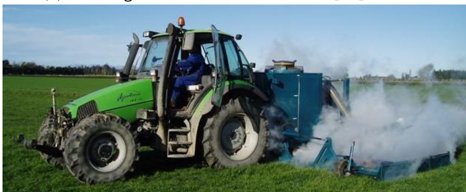
Рис 2. Парове прополювання Шість метрів ширини 1,2 МВт пара Джерело: DFSW. – Режим доступу:
