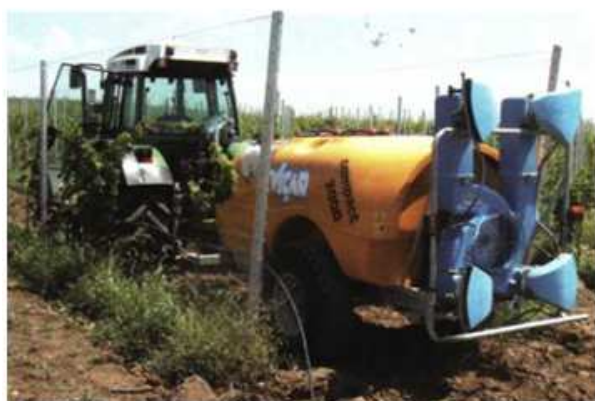
Рисунок 3 – Оприскувач вентиляторний: а) фірми «Sleza 1000 Millenium», б) фірми «Rafal», в) фірми «Vicar»
