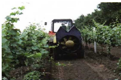
Рисунок 2 – Оприскувач вентиляторний а) фірми «SLV-1500», б) фірми «BAB Turblow 1500L»
