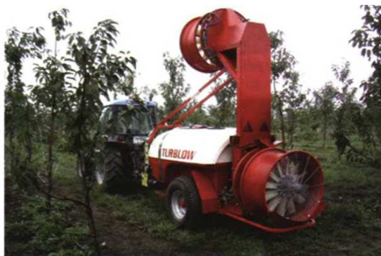
Рисунок 2 – Оприскувач вентиляторний а) фірми «SLV-1500», б) фірми «BAB Turblow 1500L»
