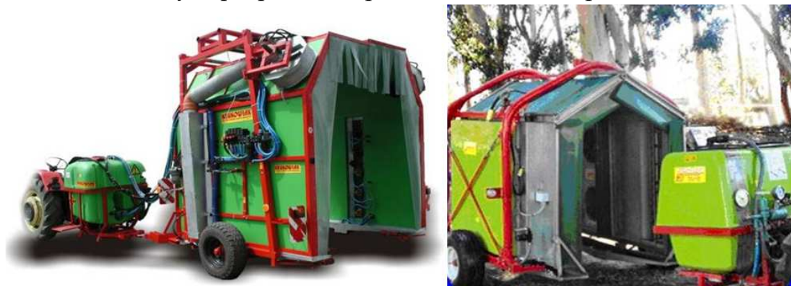
Рисунок 4 – Садовий тунельний обприскувач а) «EKOSAD – TUNEL», б) «Wine Tunnel»
