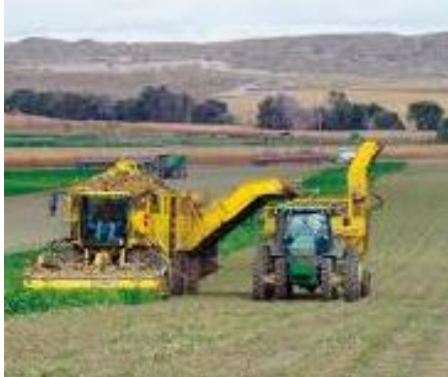
Рис..1 Завантаження коренеплодів з бункера комбайна ROPA euro-Tiger в причіп RUW HAWE
