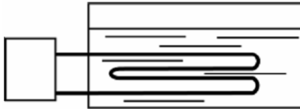
Рис. 3. Підігрів сировини за допомогою водонагрівуючого котла
