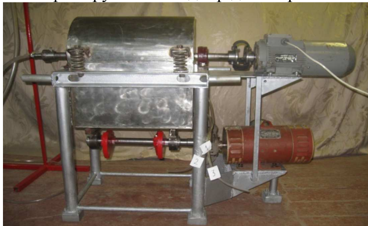
Рис. 1 – Загальний вигляд вібровідцентрової машини для очищення сирого гліцерину
