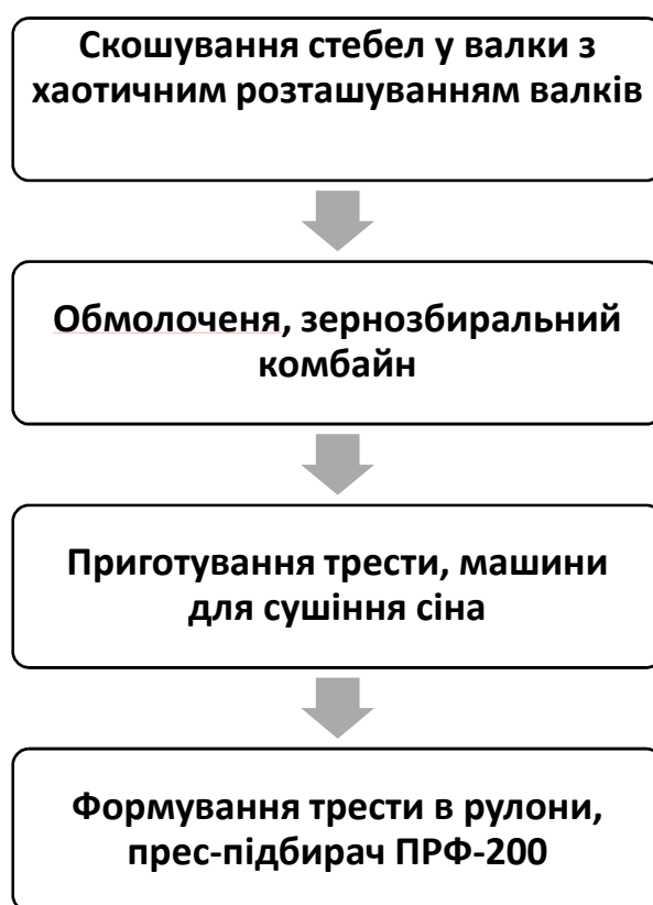
Рис. 3. Технологія збирання льону-довгунця з використанням машин загального призначення.
