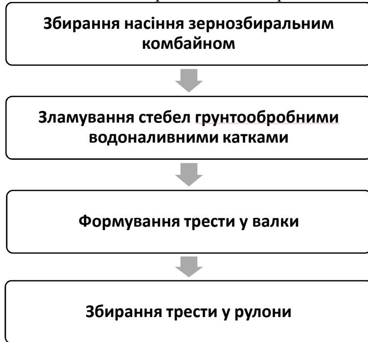
Рис. 2. Послідовність виконання операцій за комбайновою технологією збирання насіннєвих конопель
