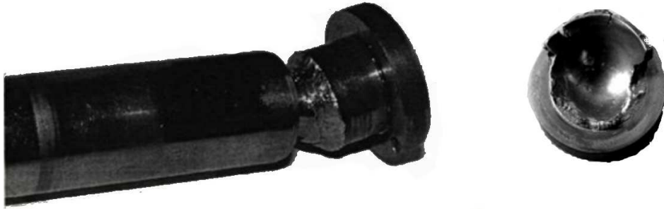
Рис. 2. Вигляд можливого спрацювання поршня та підп'ятника
