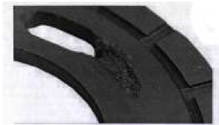
Рис. 3. Зовнішній вигляд дефектного сталевго розподільника
