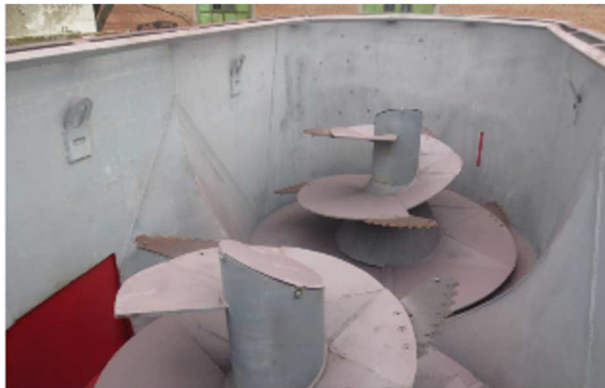
Рис. 2. Спеціальні шнеки кормозмішувача-роздавача "ДЕМІ-МІКС"
