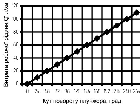
Рис. 2. Тарувальна характеристика витратоміра постійного перепаду тиску.
