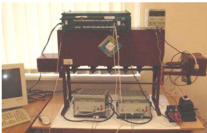
Рис. 5. Лабораторна установка дослідження програмно-апаратного модуля керування змінними нормами сівби
