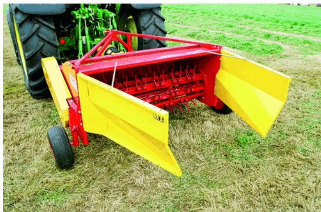
Рис. 3. Машина для плющения стеблей скошенных трав Super-ted 221, оснащенная кондиционером
