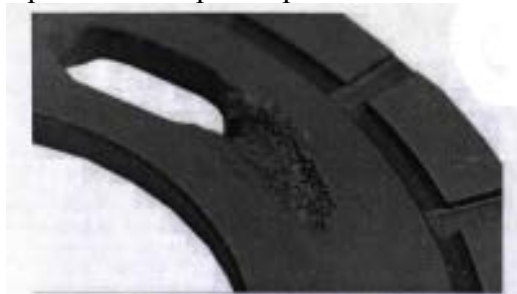
Рисунок 3 – Зовнішній вигляд дефектного сталюого розподільника
