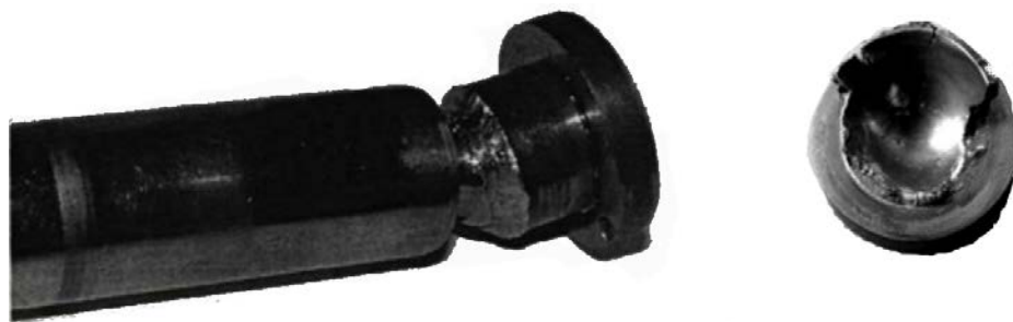
Рисунок 2 – Вигляд можливого спрацювання поршня та підп'ятника
