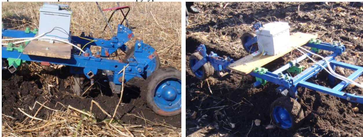
Рис. 4 – Накопичування рослинних решток на електродах
