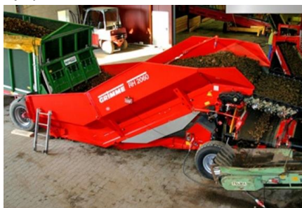
Рис. 1. Поточна лінія післязбиральної обробки картоплі фірми GRIMME
