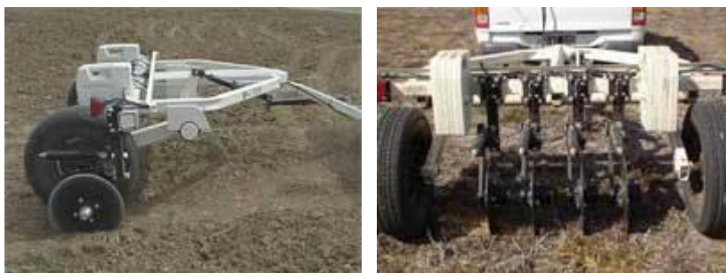
Рис.4 - Система реєстрації електропровідних властивостей ґрунту Veris
