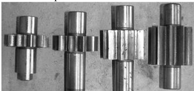
Малюнок 4 - Фотографії шестерень НШ, подачу яких збільшує шляхом збільшення ширини вінців шестерень - b (Кіровоградське ВАТ «Гидросила»)
