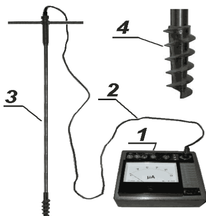
Рис.1 – Вимірювач параметрів ґрунтів ВПГ-1:
